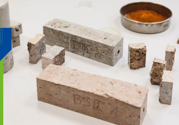
Transformation des terres excavées du Grand Paris Express en béton bas carbone
