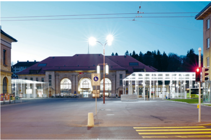
Devant la gare de la Chaux-de-Fonds, le sol simple et continu ne spécialise pas les différents espaces fonctionnels et, ce faisant, favorise leur évolutivité. L'éclairage nocturne est hiérarchisé et limité aux différents espaces à éclairer : rétroéclairage des abris, éclairage intérieur de la gare et mât unique sur le parvis. (Frundgallina)
