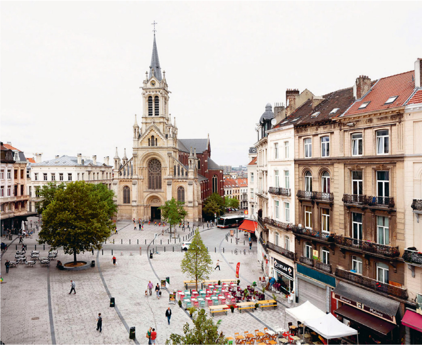
Sur le parvis Saint-Gilles à Bruxelles, un sol au dessin et au nivellement continu et une disposition et un écartement des potelets adapté favorisent la continuité et la liberté des parcours piétons. (Bureau Bas Smets)
